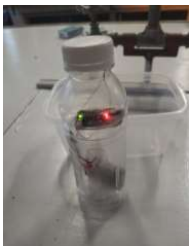
Fig. 8. Dispositivo final utilizado con el Arduino nano en su interior.
